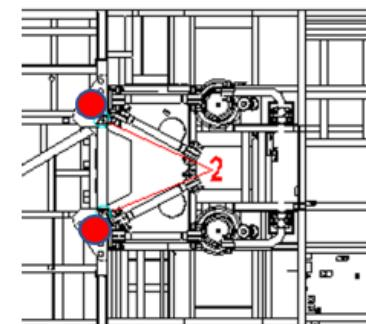
図 3-3 後車軸リジットラック位置
