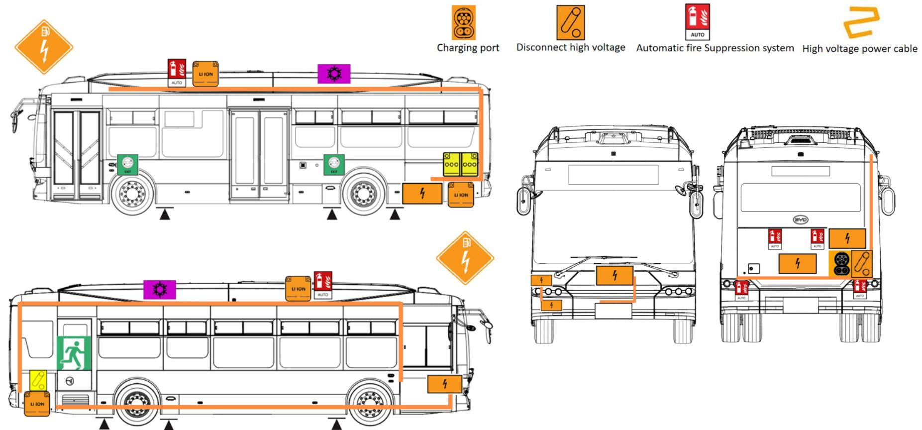
図 1 バッテリー・高電圧ハーネス取付の位置
