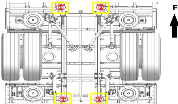
図 3-3 後車軸リジットラック
