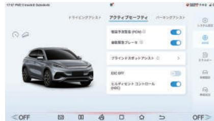
**HDC 機能を OFF にする場合は、再度 HDC アイコンをタッチします。**このとき、コンビネーションメーターの表示灯が消灯します。また、速度が約 65km/h を超えると、HDC は自動で OFF になります。
