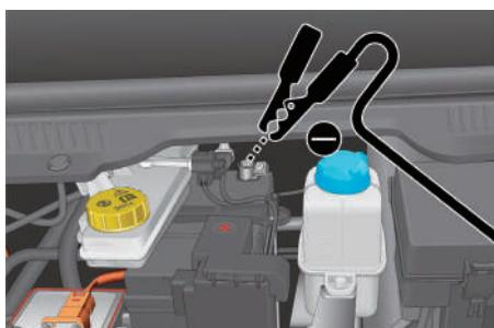
5. 黒い負極（-）ケーブルのもう片側を自車の適切な接続部（きれいで塗装されていない、しっかりと接地された金属部分）に接続します。
