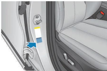
チャイルドロックのマークは、左／右リアドア板金の表面に刻印しています。
