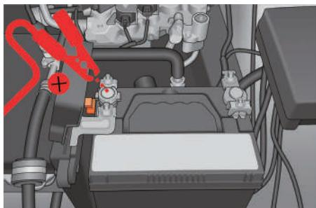
3. 赤い正極（+）ブースターケーブルのもう片側を救援車の電圧がかかっているバッテリーの正極（+）端子に接続します。
