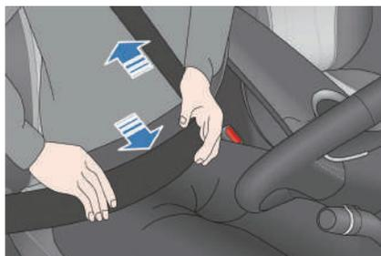
3. タングプレートをバックルに「カチッ」と音がするまで押し込んでから、反対方向にタングプレートを引っ張り、確実にロックできたかを確認します。シートベルトにねじれがないように注意してください。
