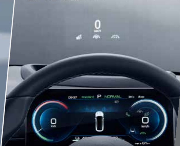
速度や安全支援機能を表示するヘッドアップディスプレイ
