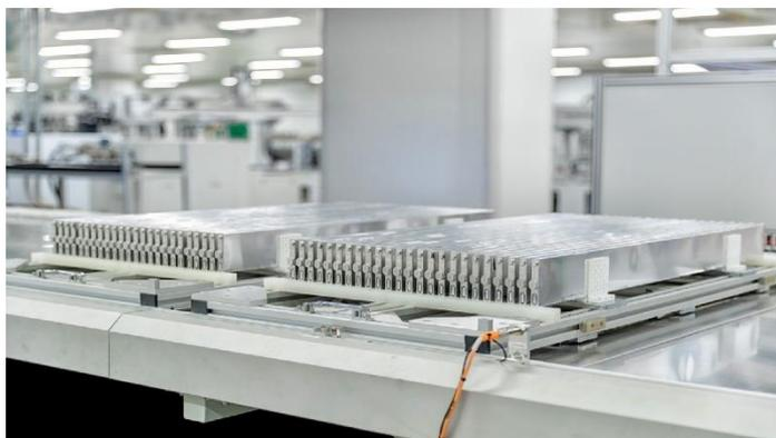
「ブレードバッテリー」は、BYD が 2021 年に発表した最新型のリン酸鉄リチウムイオン電池（以下、LFP）です。釘刺し試験や高温試験などの各種試験をクリアしており、LFP 本来の高い安定性を確保していることに加え、BYD の革新的な技術によって LFP の弱点であったエネルギー密度が低い点（電気自動車においては、航続距離が短くなってしまう点）をカバーしました。
