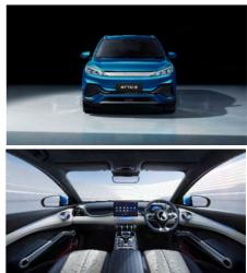
「ATTO 3」は、2022 年 2 月に中国で販売を開始して以降、シンガポールやオーストラリアなど中国国外でも好評を得ています。 BYD が独自開発した「ブレードバッテリー」を搭載した EV 専用のプラットフォーム「e-Platform 3.0」を採用し 485km の航続距離(WLTC 値\*1)と高い安全性、フラットな床面によって広い車内空間と 440L の荷室容量を実現しました。
