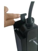
図7 制御ボックスの取り外し操作の概略図
