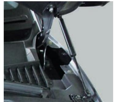
ボンネット開閉を支援するダンパー。収納ボックスと同時に装着ください。
