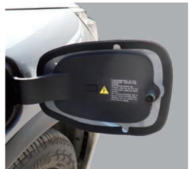
給電口の汚れを防止するシリコン製の防塵ゴムシール。
